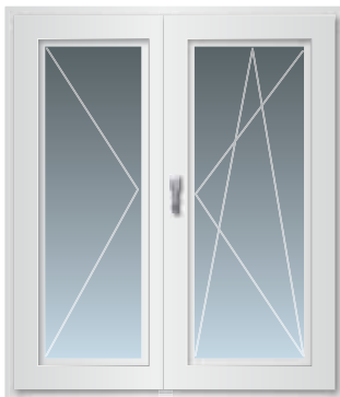
Dreh-Drehkipptür mit Stulp (ohne Pfosten)
